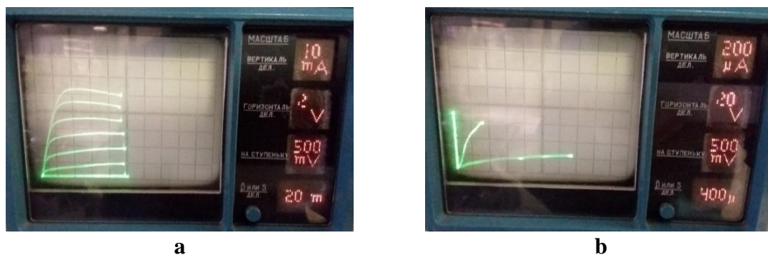
Рисунок 4. а. ВАХ тестового транзистора. б. Измерение тока утечки закрытого транзистора.
